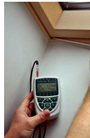
Lokalizacja nieszczelności z zastosowaniem termoanemometru
